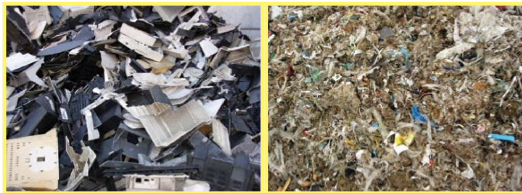
Abbildung 176: Kunststoffe von Monitorrückwänden mit weit mehr als 0,2 % Bromgehalt, wobei die POP-Grenzwerte überschritten wurden – Y48 (bzw. EU48)
